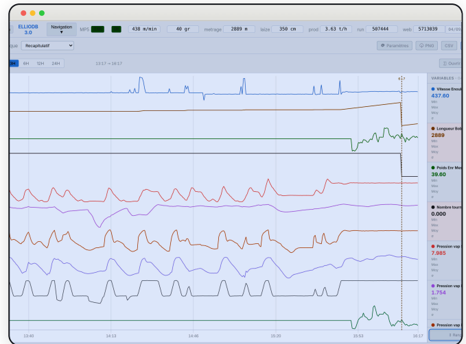
Historique. Courbes multi-variables en temps réel ou sur archive : zoom, statistiques, corrélations, jusqu'à dix courbes superposées par page.
